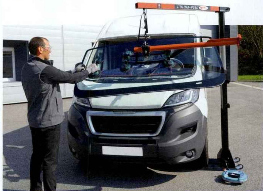
Les portiques d'aide à la pose, comme l'Ultra Pose Evolution de chez VBSA, permettent à un compagnon de manipuler seul un large pare-brise.
